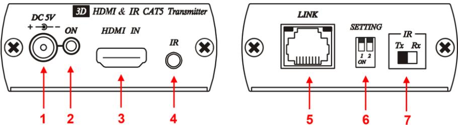
Рис.3. Обозначение элементов передней и задней панели SR02ET
