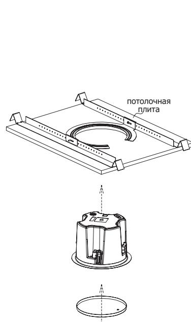
\*потолочное отверстие Ø 200~205 мм
