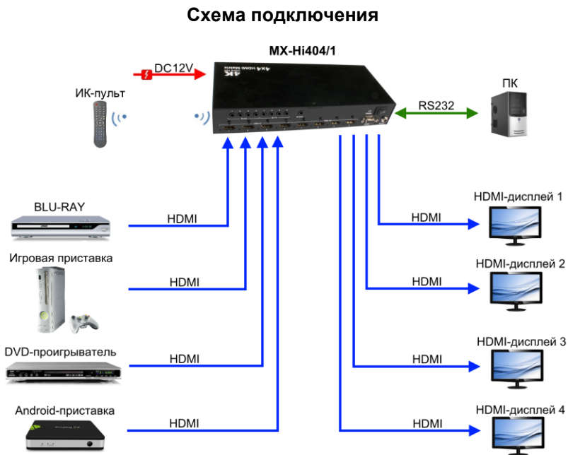
Рис.5 Типовая схема подключения HDMI-коммутатора MX-Hi404/1
