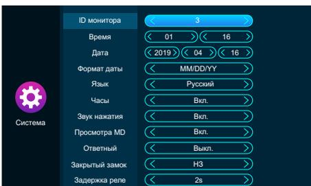
【ID монитора】 означает идентификатор внутреннего устройства, диапазон от 1 до 6. 1 означает, что монитор является основным, 2 - 6 означает, что внутренние мониторы являются дополнительными. Каждый блок поддерживает максимум до 6 мониторов.
