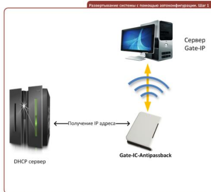
Рис 6. Подключение контроллера Gate-IC-Antipassback
