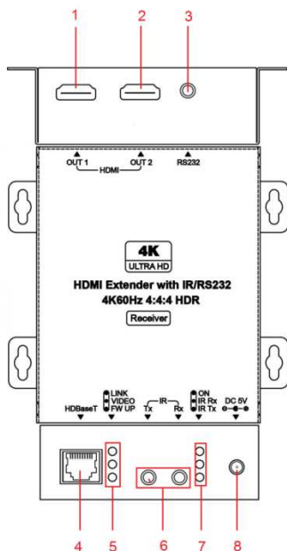
Рис.4 Приемник HE02EIXR, разъемы и индикаторы передней и задней панелей
