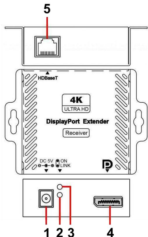
Рис. 4 Приемник DP02ER, разъемы и индикаторы на передней и задней панелях
