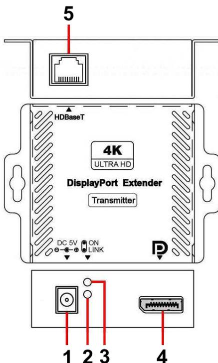
Рис. 3 Передатчик DP02ET, разъемы и индикаторы на передней и задней панелях
