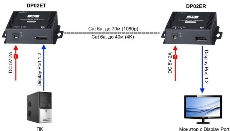
Рис.5 Типовая схема подключения комплекта DP02E
