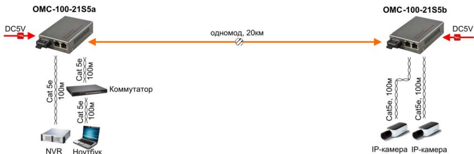
Рис. 7 Схема подключения медиаконвертеров OMC-100-21S5a (OMC-100-21S5b)
