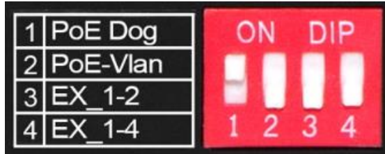
Рис.4 DIP-переключатель режимов работы коммутатора SW-70500-I
