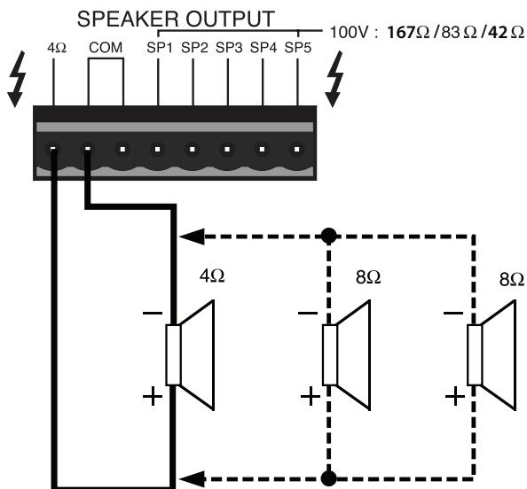
При использовании трансляционных громкоговорителей соблюдайте полярность. 100 В линия формируется с помощью выходного согласующего трансформатора.
