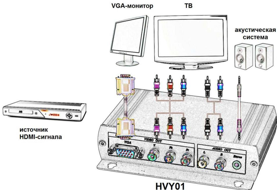
Рис. 4 Схема подключения преобразователя HVY01.
