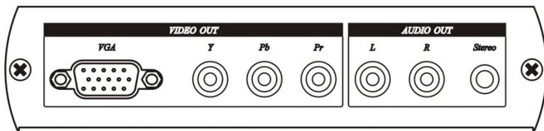
Рис.3 Разъёмы HVY01.
