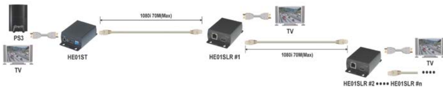
Рис.10 Схема подключения передатчика HE01ST и приемника HE01SLR.
