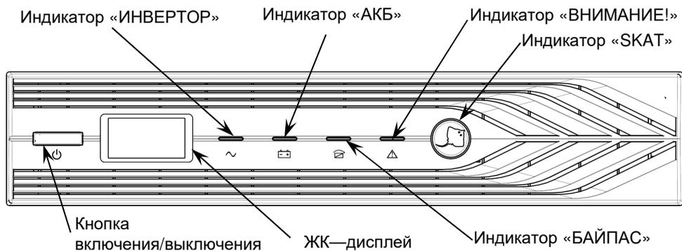
Рисунок 1 – Общий вид передней панели изделия.
