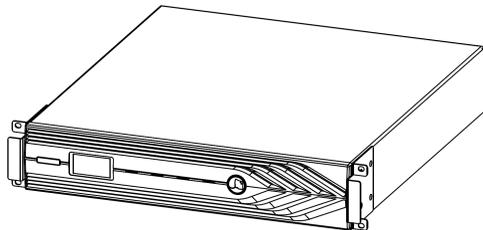
**Изделие выполнено** в металлическом корпусе с перфорированной пластиковой передней панелью, на которой расположены: кнопка включения/выключения, ЖК—дисплей и светодиодные индикаторы (см. рисунок 1 и приложение 3).
