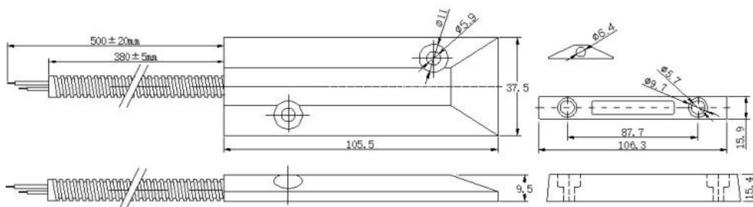
Извещатель магнитоконтактный ST-DM140NC-SL предназначен для контроля положения различных строительных конструкций (дверей, окон, люков, ворот и т.д.). Данное устройство может использоваться в системах охранной сигнализации или контроля и управления доступом.
