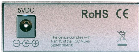
Рис.2 Вид сзади медиаконвертеров OMC-1000-11S5a (OMC-1000-11S5b)
