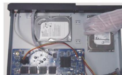
Шаг 2: придерживая жесткие диски, аккуратно переверните регистратор и закрепите их на дне корпуса устройства при помощи винтов. Затем подключите кабель данных и кабель питания и расположите их таким образом, чтобы их не зажимало при закрытии верхней крышки устройства. Установите верхнюю крышку регистратора.
