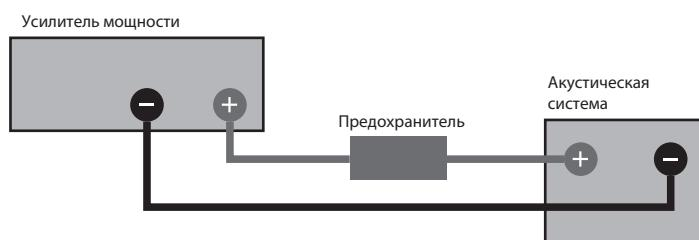
Для определения номинала предохранителя используйте следующую формулу:
