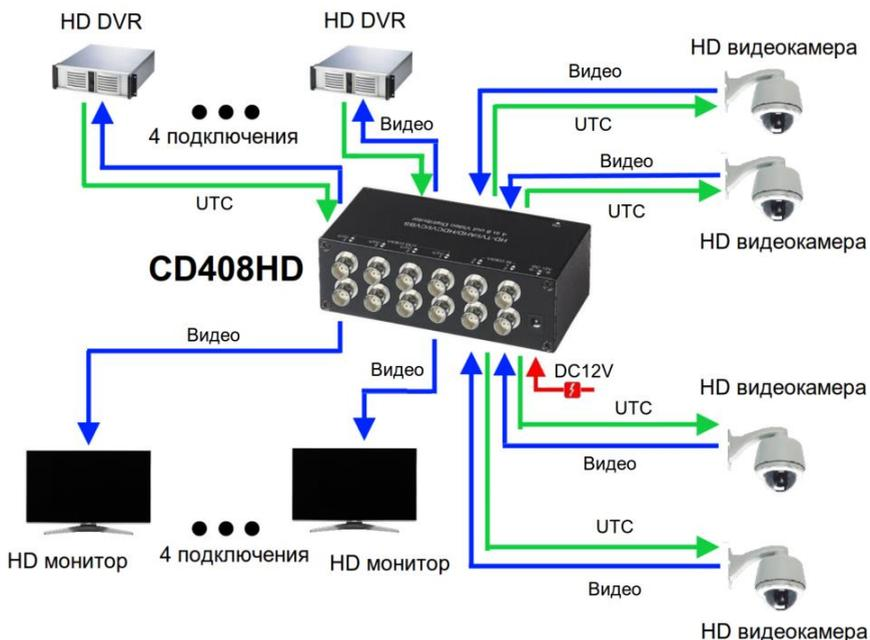
Рис.3 Схема подключения приемника CD408HD. Режим Video + UTC
