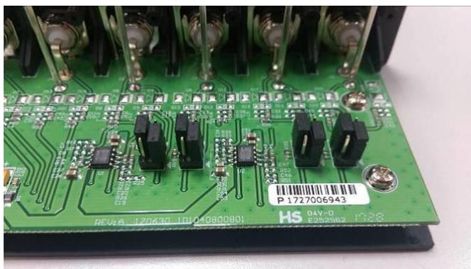
Рис.4 Перемычки выбора режима работы
