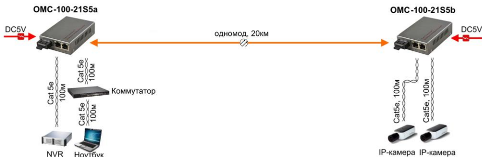
Рис. 7 Схема подключения медиаконвертеров OMC-100-21S5a (OMC-100-21S5b)
