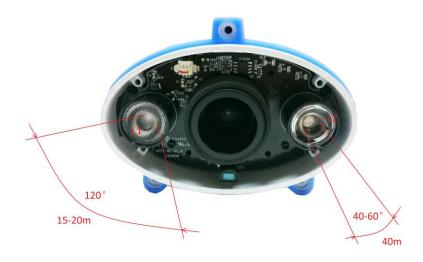
Камера использует две линзы для коррекции ИК потока:
