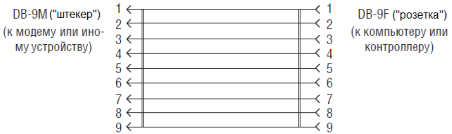
Рис.7 Распайка «нуль - модемного» кабеля интерфейса RS232.
