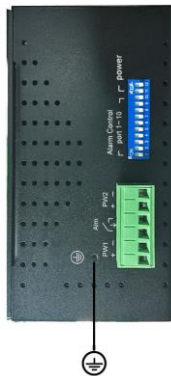
Рис.7 Заземление коммутатора SW-80822/IR
