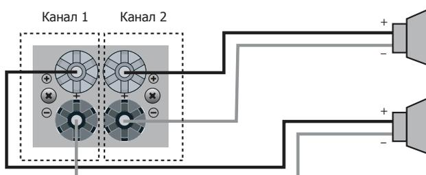
Подключение акустических систем при помощи двух разъемов Speakon
