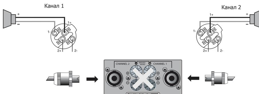
Подключение акустических систем при помощи одного разъема Speakon
