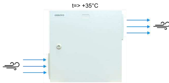
Рис. 27 Принцип работы системы проточной вентиляции
