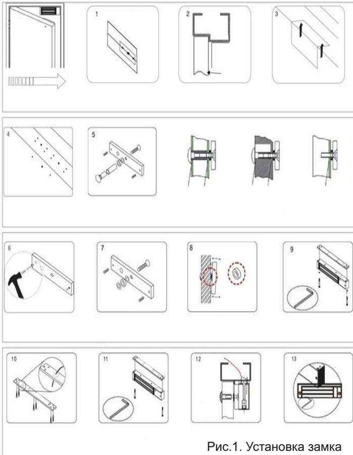
Рис.1. Установка замка
