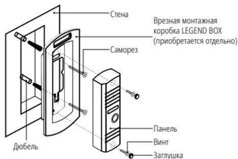
Рис. 8 Врезная установка вызывной панели LEGEND
