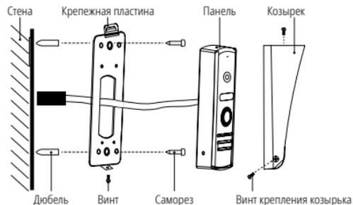
Рис. 9 Фронтальная установка вызывной панели MASK
