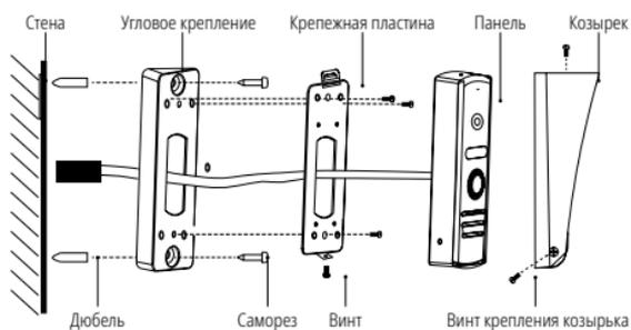
Рис. 10 Установка вызывной панели MASK под углом 30°
