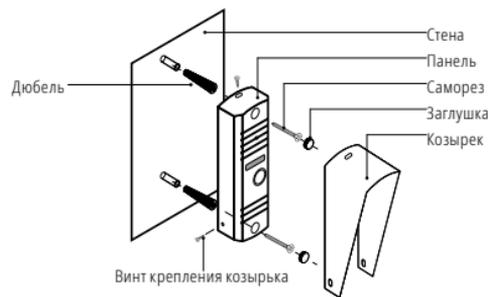
Рис. 6 Фронтальная установка вызывной панели LEGEND
