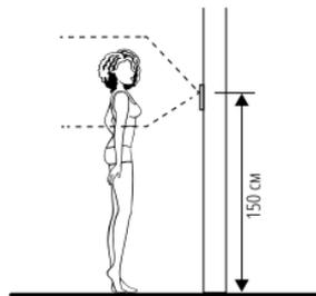
Рис. 4 Рекомендуемая высота установки видеопанели
