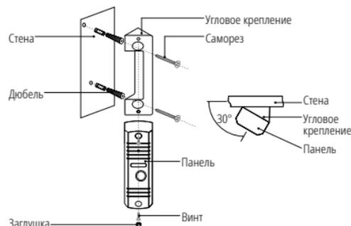
Рис. 7 Установка вызывной панели LEGEND под углом 30°
