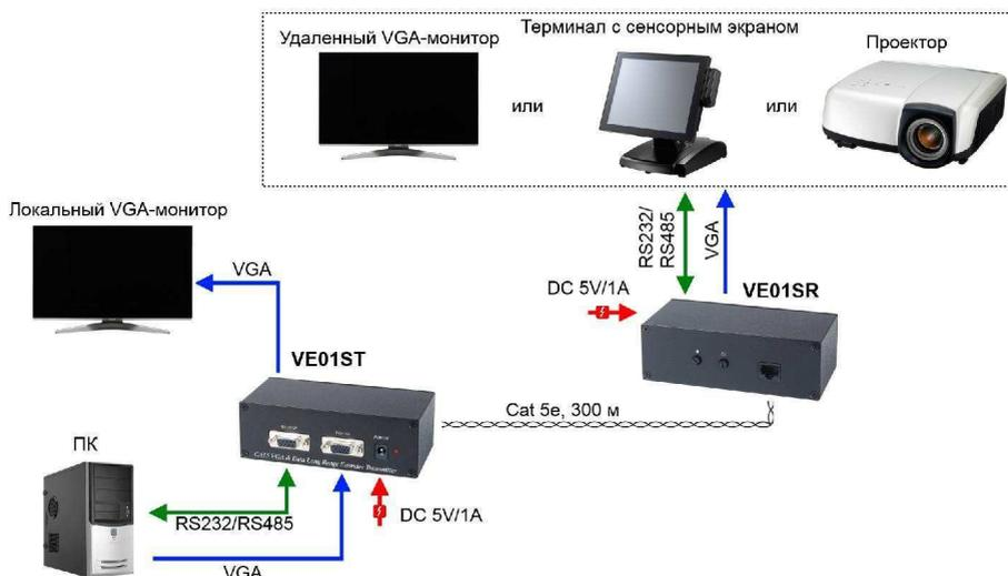
Рис.5 Схема подключения VE01S
