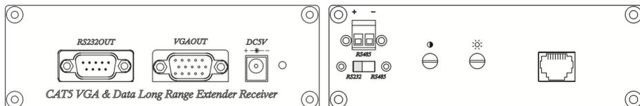
Рис.4 Разъёмы VE01SR
