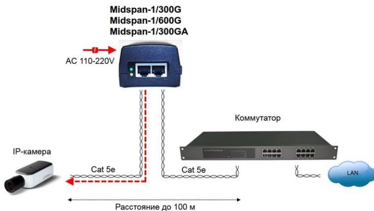
Рис.3 Схема подключения
