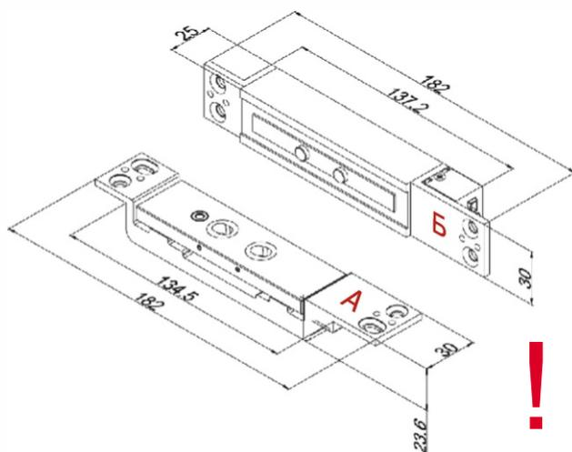
**ВНИМАНИЕ: Зазор между плоскостями А и Б должен быть не более 3 мм!
