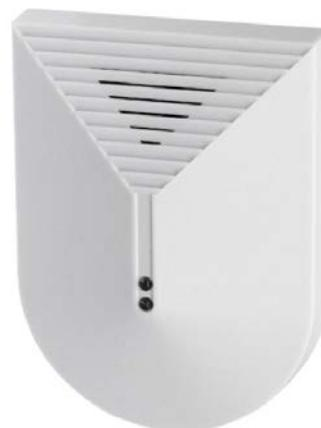
Акустический извещатель разбития стекла ST-AD010G предназначен для обнаружения разрушения остекленных конструкций в охраняемом помещении. Комбинированное использование 2-х диапазонного детектирования, возможности регулировки чувствительности отдельно для каждого диапазона и цифровой обработки сигнала позволяет минимизировать количество ложных срабатываний.
