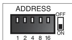
1.) Установите сетевой адрес устройства при помощи DIP переключателя, расположенного на задней стенке PB-6207.
