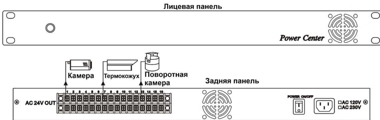
Рис. 3 Схема подключения блока питания PR1616-12R
