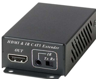
Рис. 3 Вид спереди приёмника HE02EIR
