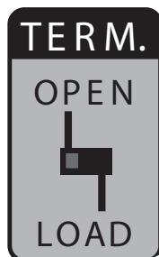
При подключении блока DIB-6000 к шине управления RS-485 необходимо произвести включение или отключение терминального резистора с помощью переключателя TERM.
