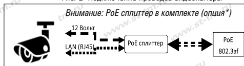
Рис.3 Схема подключения PoE
