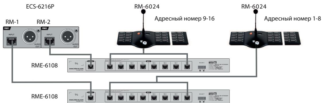
3. При подключении блоков TP-6231A ко входам RM1 - RM4 контроллера PX-6216 адресные номера телефонных контроллеров должны быть соответственно 1,2,3 и 4. При подключении блоков TP-6231A ко входам RM1 - RM4 контроллера PX-6216 через блоки расширения RME-6108 адресные номера телефонных контроллеров или микрофонных панелей, подключенных к одному и тому же блоку расширения, должны быть разными в пределах от 1 до 8.
