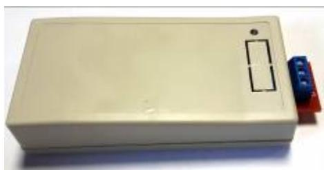
**Описание изделия:** Преобразователь Gate-USB/485 предназначен для подключения к персональному компьютеру устройств, имеющих интерфейс RS-485.
