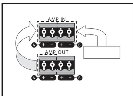
Использование встроенного усилителя (для канала B) совместно с внешним усилителем (для канала A).
