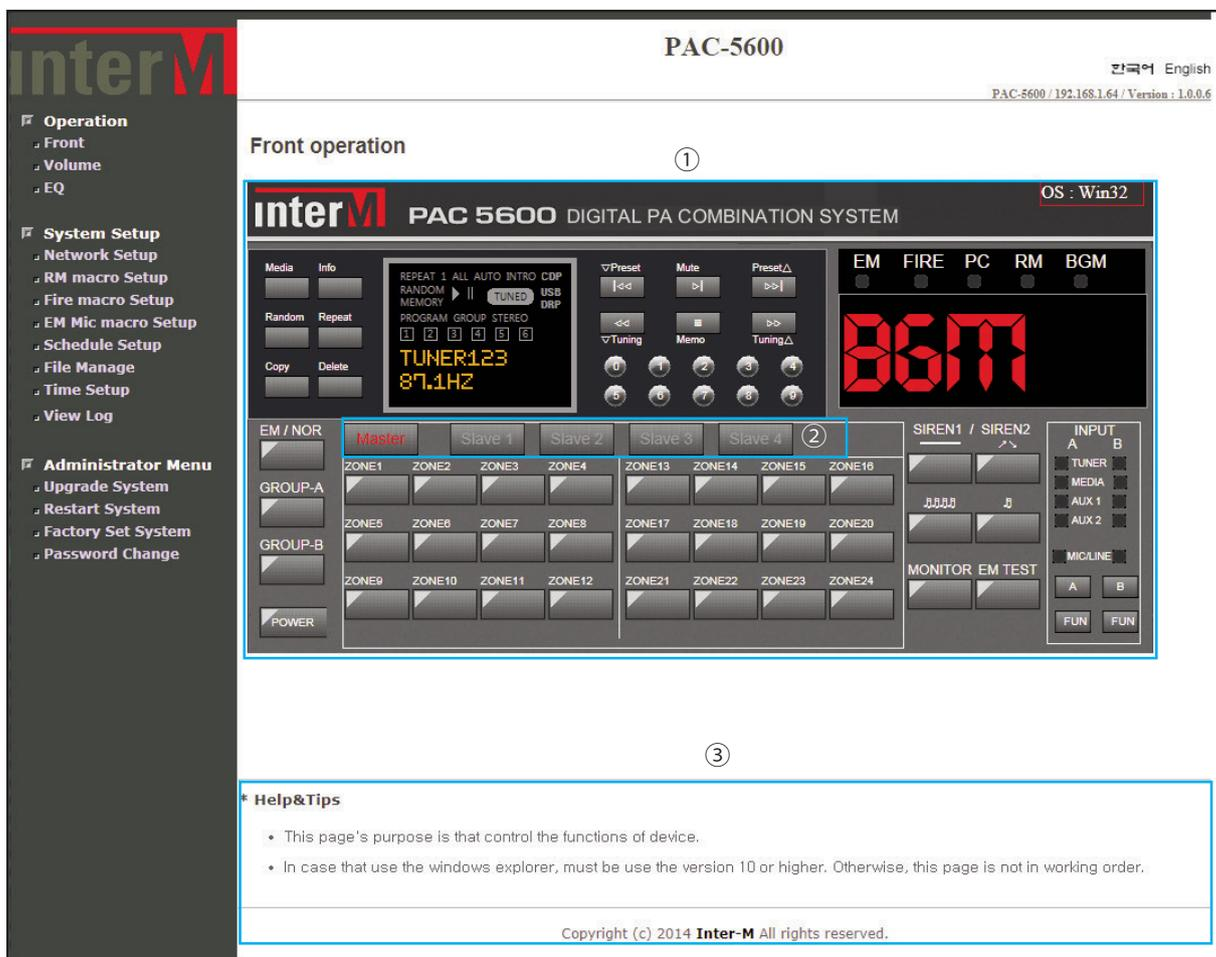
① Виртуальные органы управления почти полностью дублируют переднюю панель PAC-5600 (кроме ручного управления эвакуацией и первичной настройки тюнера) и позволяют управлять работой устройства через WEB-интерфейс так же, как при непосредственном контакте с моноблоком - см. Руководство пользователя PAC-5600.
