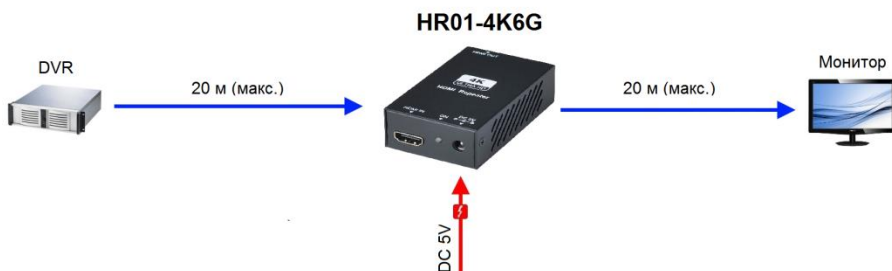
Рис.3 Схема подключения HR01-4K6G
