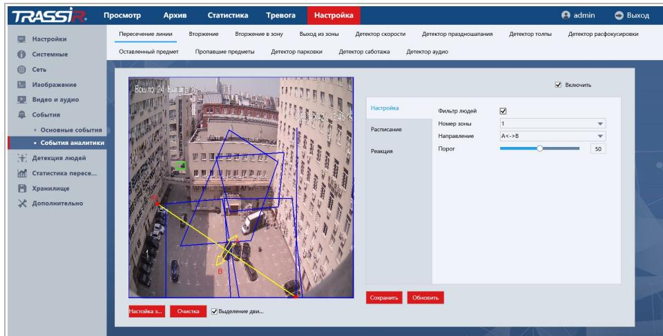
Нажмите кнопку **Настройка з... [Plot area]** или левой кнопкой мыши на экране просмотра и добавьте линию. Для каждой линии можно задать следующие настройки:
