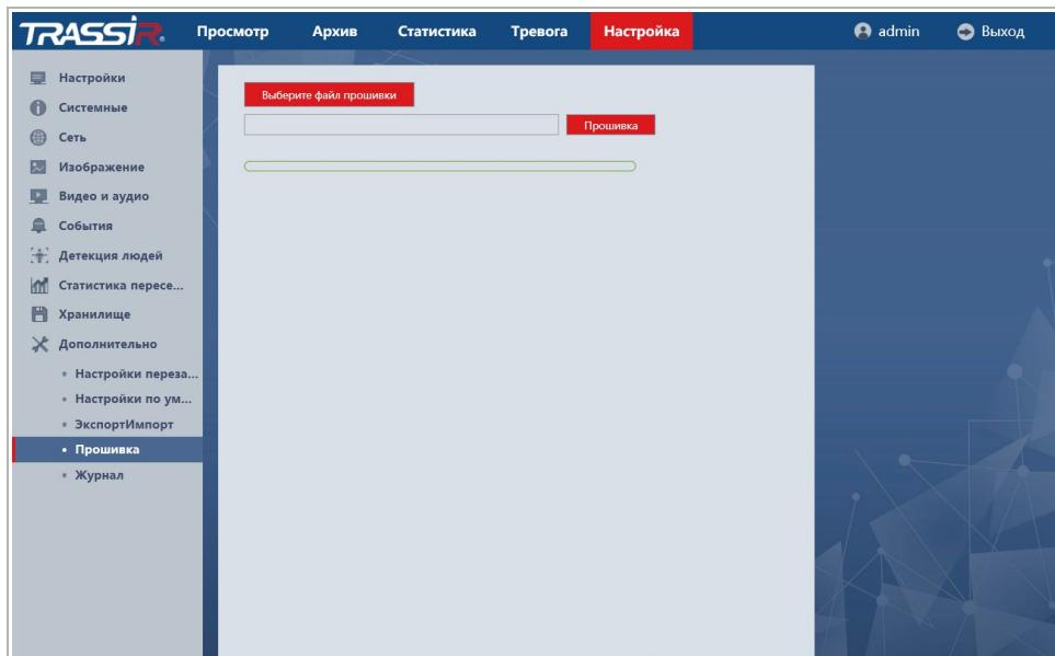
Для обновления программного обеспечения (прошивки) IP-камеры нажмите кнопку **Выберите файл прошивки [Browse]** и укажите файл с программным обеспечением. Чтобы начать загрузку файла нажмите кнопку **Прошивка [Upgrade]**.
