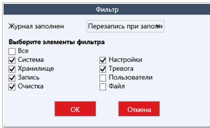
В поле **Журнал заполнен [Log full]** выберите действие при заполнении журнала: **Перезапись при заполнении [Log full coverage]** или **Отключено [Stop]**, а в списке ниже — выберите элементы фильтра для перезаписи или отключения при заполнении журнала.
