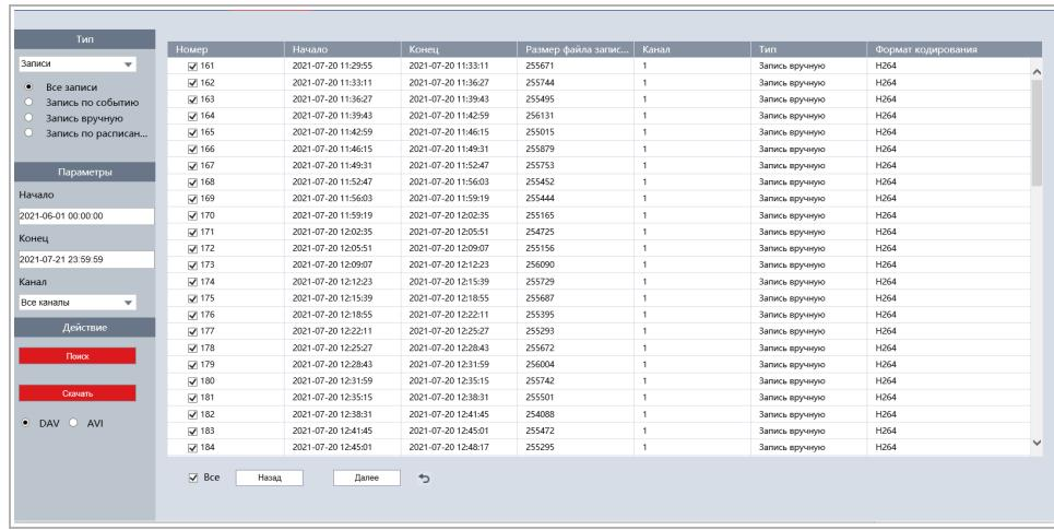
В блоке **Тип [Type]** выберите файлы для скачивания: **Записи [Record]** или **Кадры [Picture]**, а также выберите тип записей — все, по событию, вручную или по расписанию — проставив соответствующие флаги.
