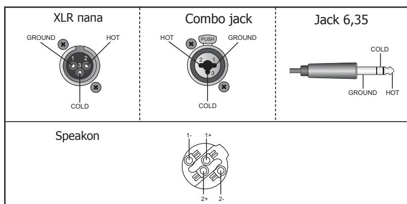
В стереорежиме используются + (положительный) и - (отрицательный) выходы усилителя от каждого канала (CH1: 1+, 1-; CH2: 1+, 1-).
